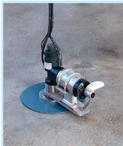
**Bild 1:** Schwenkrührwerk UFT-FluidSway (Prototyp)
